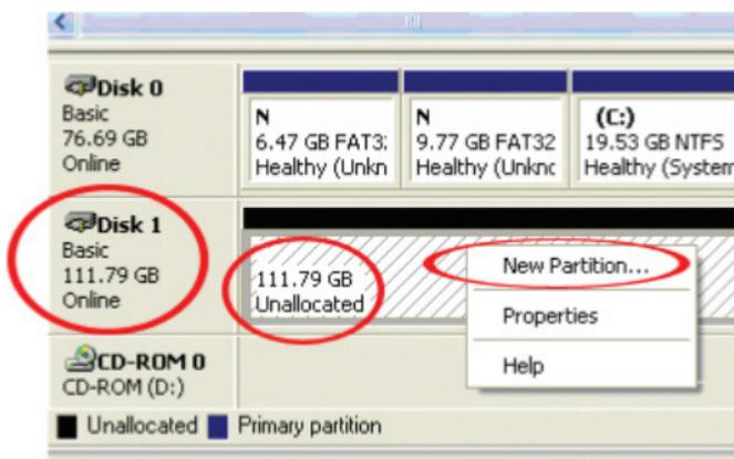
3. 初期化が完了したら、「未割当」となっているディスクを指定し（一覧表示されているHDD容量を見て、正しいHDDが指定されているかどうかを確認します）、「未割当」となっているセクションを右クリックし、「新規パーティション」を選択します。
